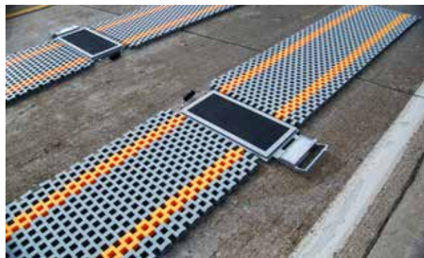
Schneller und unkomplizierter Aufbau der LS630-WIM™ -Waage mit Aufrollrampen, um Fahrzeuge im dynamischen oder statischen Modus zu wiegen.
